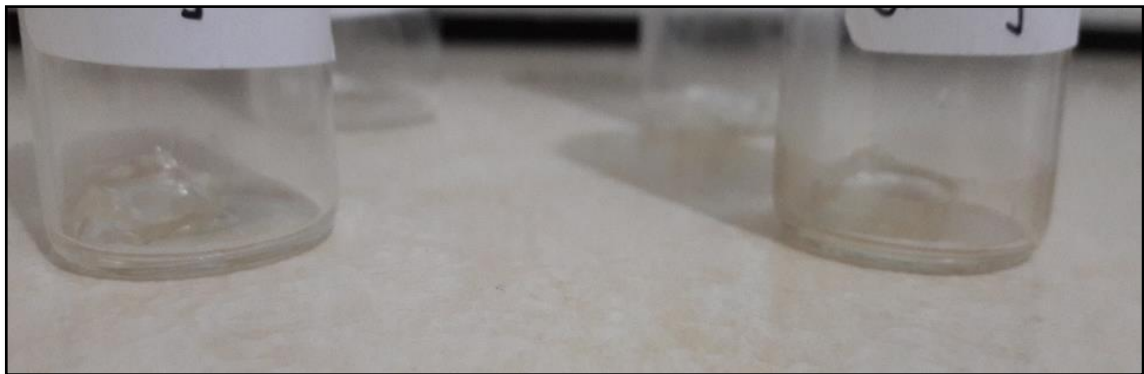
Figura 2.4 Adición de la solución de KTP a los xerogeles de CMC para realizar la carga del fármaco por hinchamiento.
