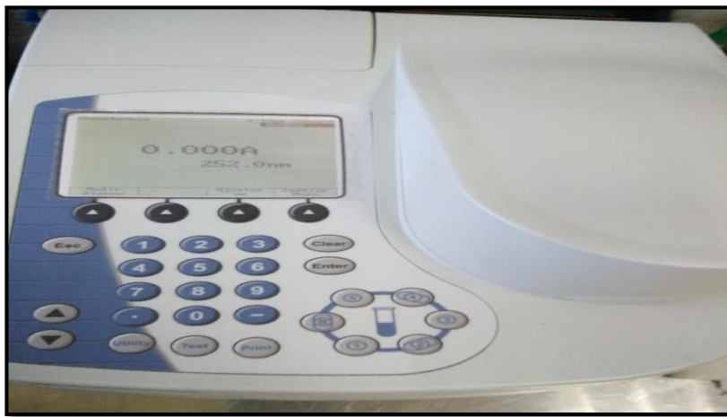
Figura. 2.5 Espectroscopia Uv-vis Genesy 10S
